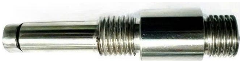
Hình 4. Chi tiết đầu phun sau khi gia công
